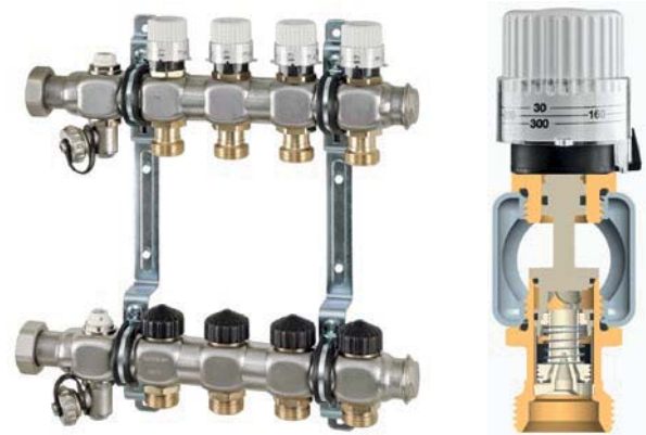
Abb. 4: Fussboden-Heizkreisverteiler mit automatischer Durchflussregelung, Bildquelle: IMI Hydronic Engineering
